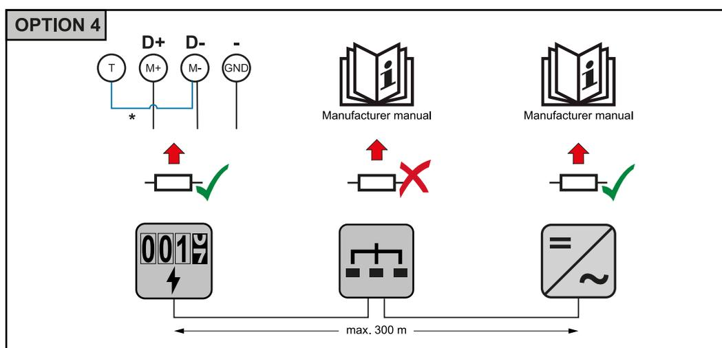
\* Der Abschluss-Widerstand ist im Fronius Smart Meter TS integriert und wird mit einer Überbrückung zwischen den Anschlüssen **M-** und **T** (T = Terminierung) hergestellt.
