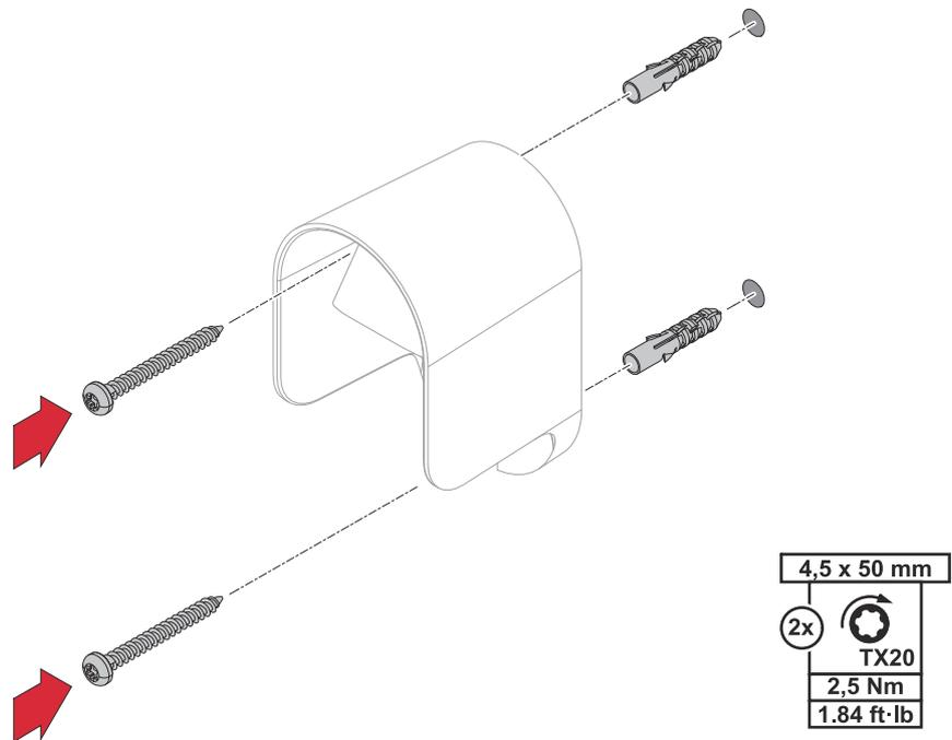
Bohrlöcher 2 mal anzeichnen und 2 Löcher bohren. Geben Sie Dübel in die Bohrungen und befestigen Sie die Kabelhalterung mit Schrauben.
