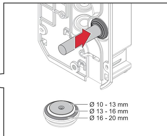
Führen Sie das 5-polige Netzkabel von hinten durch die Öffnung in das Gerät ein. Befestigen Sie die Einzeldrähte entsprechend der Abbildung. Passen Sie die Gummitülle dem Kabelquerschnitt an. Die Gummitülle schützt das Gerät vor Wassereintritt.
