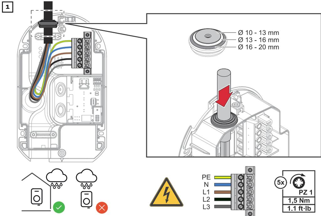
Führen Sie das 5-polige Netzkabel von oben durch die Öffnung in das Gerät ein. Stülpen Sie die Gummitülle zur Abdichtung über das Netzkabel
