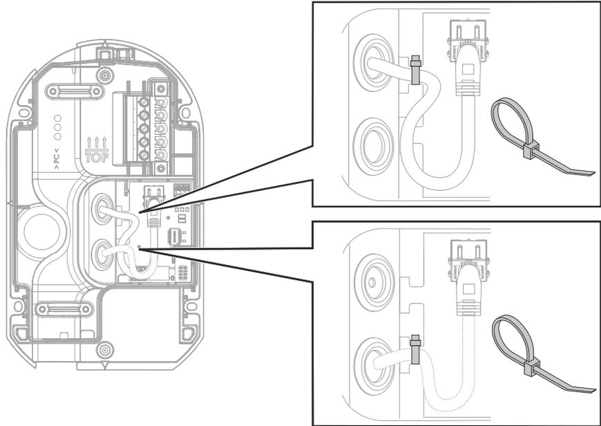
Fixieren Sie das Ethernet-Kabel mit einem Kabelbinder an einer der oben dargestellten Position.
