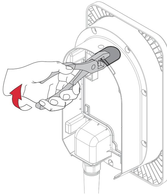
Wenn das Netzkabel von oben in das Gerät eingeführt wird, muss mit einem geeigneten Werkzeug die markierte Stelle am Gehäuse ausgebrochen werden.
