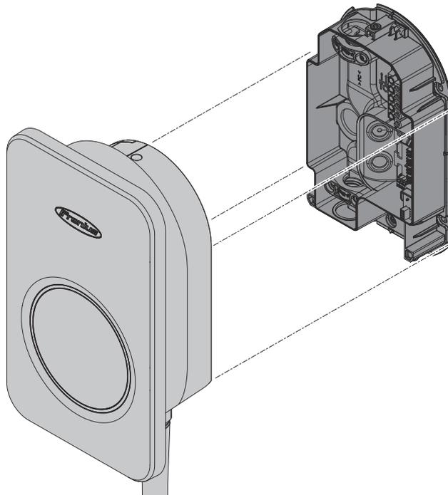
Stecken Sie den Gehäusedeckel wie abgebildet auf das Gerät.
