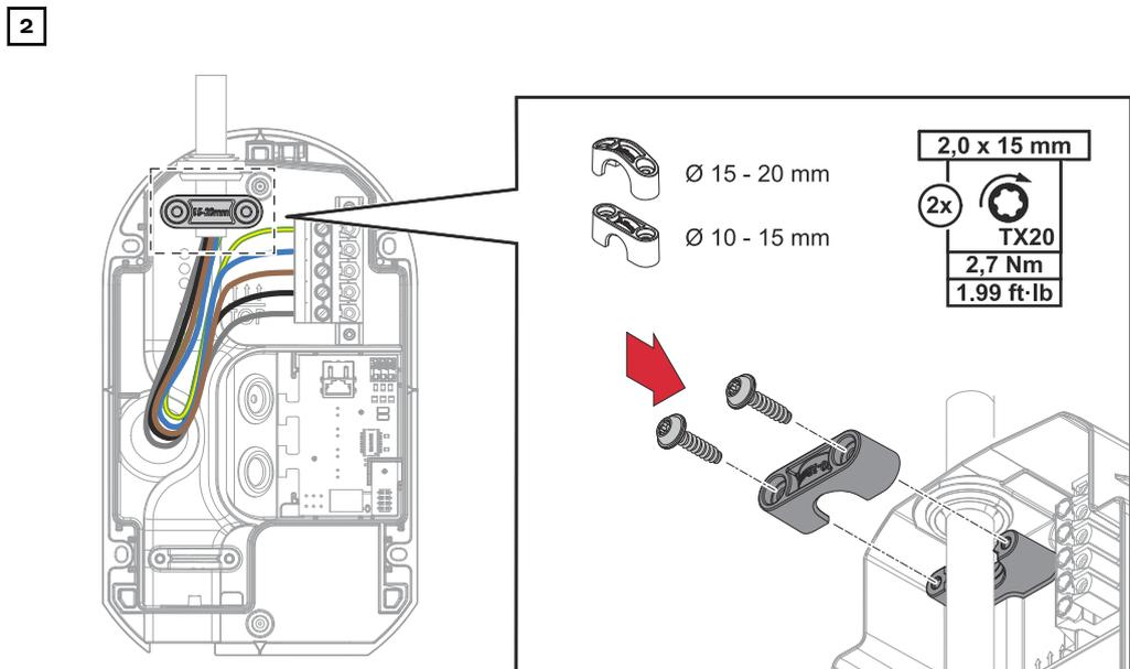
Befestigen Sie die Einzeldrähte des Netzkabels wie in der Abbildung dargestellt. Montieren Sie die passende Zugentlastung (10 - 15 mm oder 15 - 20 mm).
