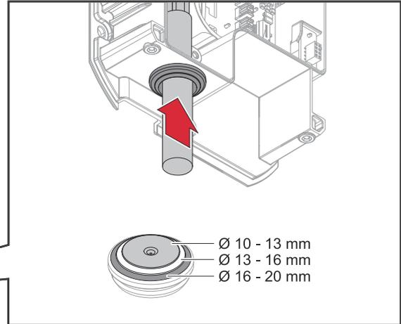
Führen Sie das 5-polige Netzkabel von unten durch die Öffnung in das Gerät ein.
