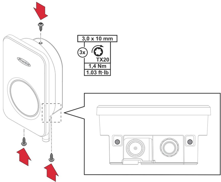
Befestigen Sie den Gehäusedeckel mit 3 Stk. 3,0 x 10 mm TX20 Schrauben.
