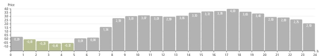
Die Abbildung zeigt die Entwicklung des Strompreis eines Stromlieferanten über 24 Stunden. Die stündlichen Tarife werden zu einer bestimmten Uhrzeit von der Strombörse für den nächsten Tag abgefragt.
