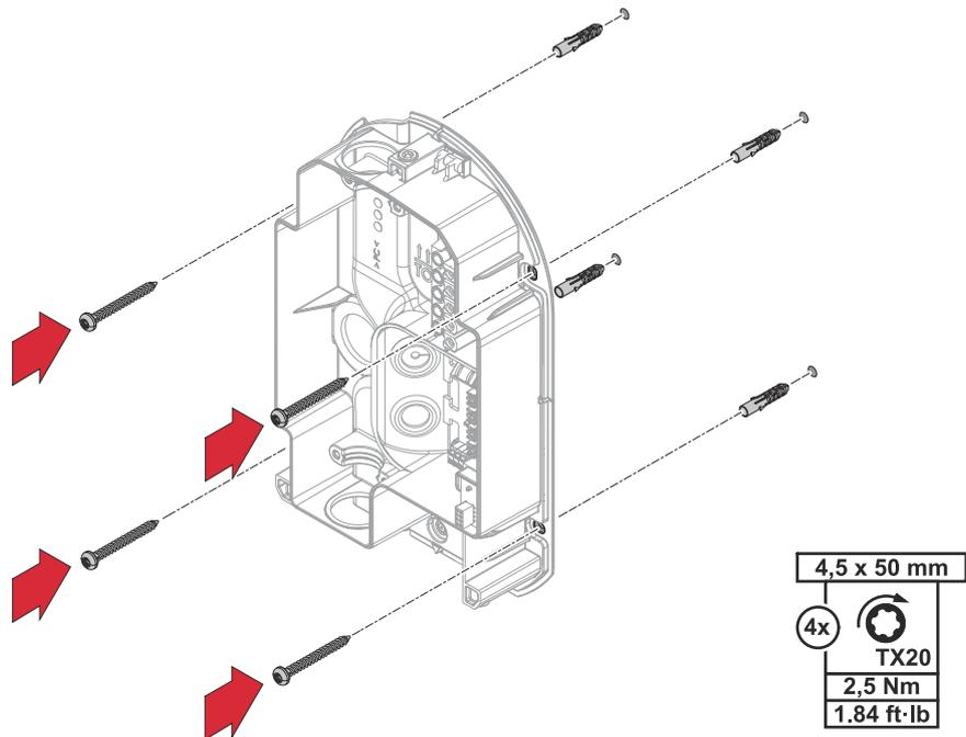
Geben Sie Dübel in die Bohrungen und befestigen Sie die Montagehalterung mit Schrauben (siehe [Lieferumfang](#)).
