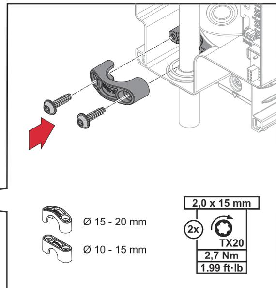
Befestigen Sie die Einzeldrähte des Netzkabels wie in der Abbildung dargestellt. Montieren Sie die passende Zugentlastung (10 - 15 mm oder 15 - 20 mm).
