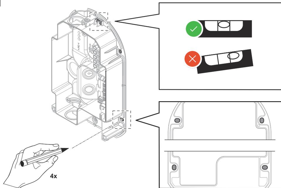
Bohrlöcher 4 mal anzeichnen. Verwenden Sie zum horizontalen Ausrichten die oben angebrachte Libelle.
